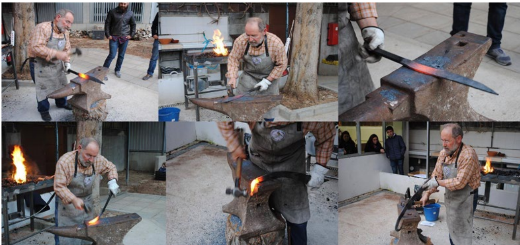
Figura 3. Imágenes de la elaboración de una falcata ibérica del curso «La memoria del hierro», impartido por el artesano Luis Albiac dentro del Máster de Arqueología y Patrimonio de la UAM (Fot. J. Baena).
